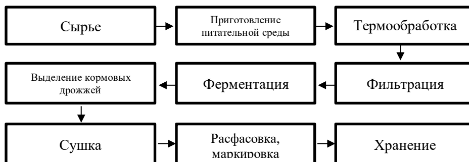
Рисунок 1. Технологическая схема получения кормового белка
