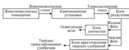
Рисунок 1. Технологическая схема кавитационной обработки жидкого навоза
