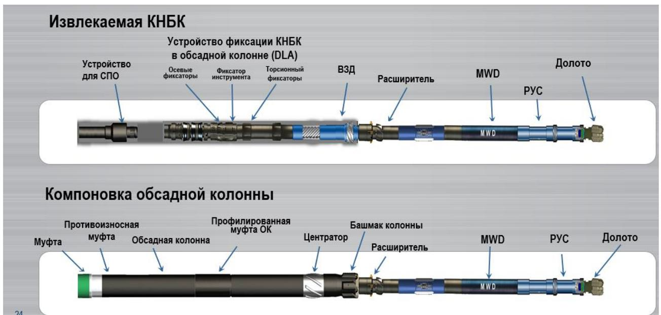
Рис. 9. КНБК для бурения CWD L3
