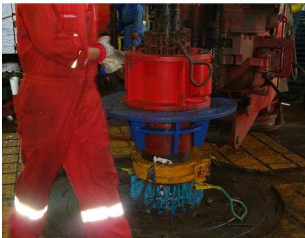
Рис. 11. Извлечение КНБК через ОК с использованием бурового инструмента 127мм.
