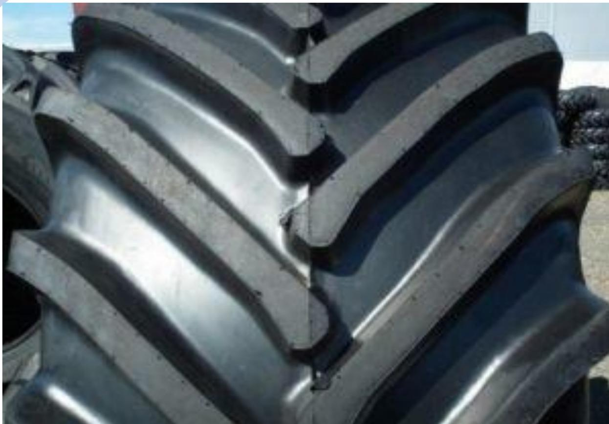
Рисунок 3. Пневмошина с протектором типа «ёлочка».
