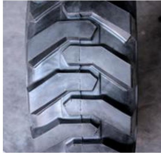
Рисунок 2. Пневматические шины с протектором типа «клюшка».
