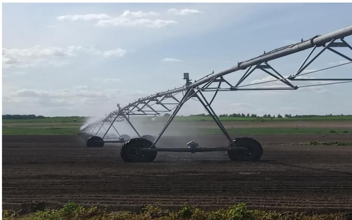
Рисунок 1. Общий вид дождевальной машины «Кубань-ЛК»
